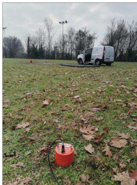
Misura del microtremore sismico mediante tecnica H.V.S.R.
